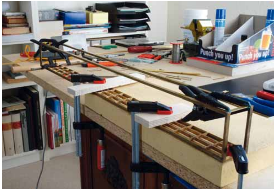
Verlöten der Seitenrahmen mit dem Fahrbahnträger. Die Brücke liegt mit der Fahrbahn nach unten auf der feuerfesten Platte (Schamottstein). Eine exakte Ausrichtung und Befestigung der Teile sind Grundvoraussetzungen für die erfolgreiche Weiterbearbeitung. Foto: R. Karpf
